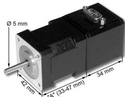
**Achtung:** An der Versorgungsspannung **muss** ein Ladekondensator von mind. 4.700 µF (siehe Zubehör) vorgesehen werden, damit beim Bremsvorgang die zul. Spannung nicht überschritten wird.
