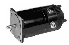
Achtung: An der Versorgungsspannung **muss** ein Ladekondensator von mind. 4.700 µF (siehe Zubehör) vorgesehen werden, damit beim Bremsvorgang die zul. Spannung nicht überschritten wird.
