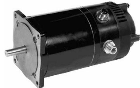
**Achtung:** An der Versorgungsspannung **muss** ein Ladekondensator von mind. 4.700 µF (siehe Zubehör) vorgesehen werden, damit beim Bremsvorgang die zul. Spannung nicht überschritten wird.
