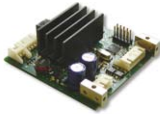
fertige Treiber-Platine mit zusätzlichen Features: Siehe SMCI21
