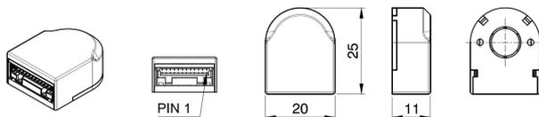
Abb. 2: NME3-xxx-xxx-xx-C1 (= geschlossener Deckel, kleines Gehäuse).
