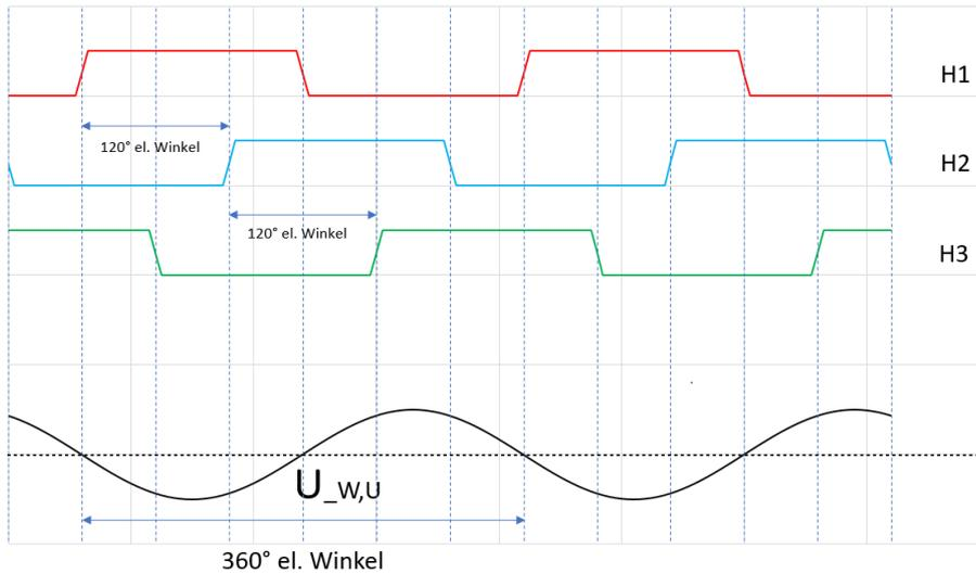
Für BLDC-Motoren sendet der NME3 auch Hallsignale. Diese konfiguriert Nanotec nur für BLDC-Motoren.
