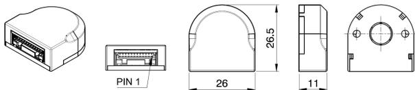
Abb. 3: NME3-xxx-xxx-xx-C2 (= geschlossener Deckel, großes Gehäuse).
