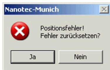
Der Fehler kann durch Betätigung der Schaltfläche <Ja> zurückgesetzt werden.
