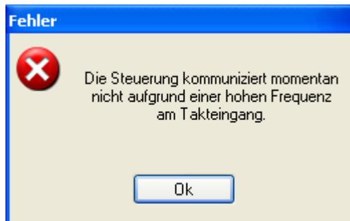
Eine Kommunikation kann erst wieder stattfinden, wenn eine Taktfrequenz kleiner 65 kHz eingestellt wird.
