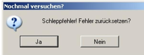
Ein Schleppfehler tritt auf, wenn sich der Motor im Drehzahlmodus befindet und entweder Closed Loop oder Fehlerkorrektur aktiviert ist und der tatsächliche Wert vom gemessenen Wert abweicht.
