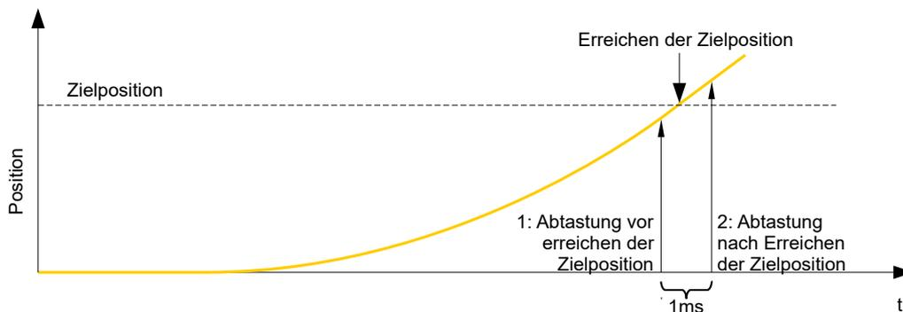
Die aktuelle Position wird einmal pro Millisekunde abgetastet. Es kann passieren, dass die Zielposition zwischen zwei Abtastungen erreicht wird. Im Falle einer Endgeschwindigkeit ungleich Null wird die Abtastung nach Erreichen der Zielposition als Grundlage für die nachfolgende Bewegung als Offset herangezogen. Demzufolge kann die nachfolgende Bewegung etwas weiter gehen, als erwartet.
