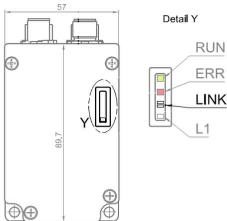
Die grüne LED *LINK* ist an, wenn das EtherCAT-Kabel angeschlossen ist und blinkt bei Datenverkehr.
