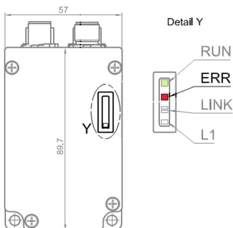
Die rote LED *ERR* zeigt einen der folgenden Status der Steuerung (*EtherCAT-Slave*) an:
