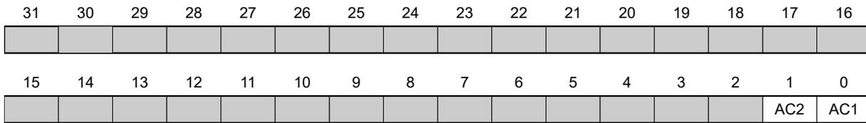
Generell gilt: Wird ein Bit auf den Wert "0" gesetzt, misst der Analogeingang die Spannung, ist das Bit auf den Wert "1" gesetzt, wird der Strom gemessen.
