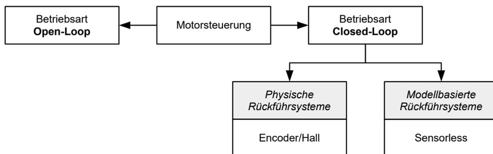
Nachfolgend werden alle möglichen Kombinationen von Betriebsarten und Rückführsystemen mit Bezug auf die Motortechnik zusammengefasst. Die Unterstützung der jeweiligen Betriebsart und Rückführung ist steuerungsspezifisch und in den Kapiteln *Anschlussbelegung* und *Betriebsmodi* nachzulesen.
