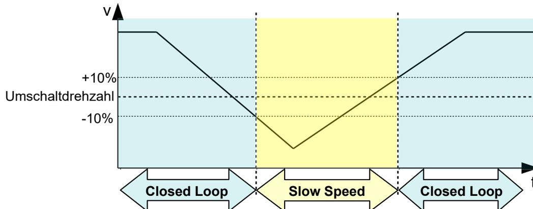
Im Stillstand befindet sich der Motor im *Closed Loop*-Betrieb.
