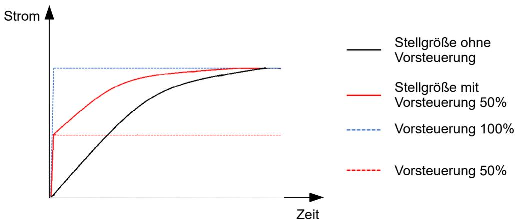
Der Faktor für die *Geschwindigkeitsvorsteuerung* wird im Objekt  $320E_h:03_h$  in Promille des Ausgangs des Rampengenerators ( $606B_h$ ) eingestellt und vor dem Geschwindigkeitsregler zum Ausgang des Positionsreglers addiert. Die *Geschwindigkeitsvorsteuerung* ist in allen Modi mit Positionsregelkreis aktiv:
