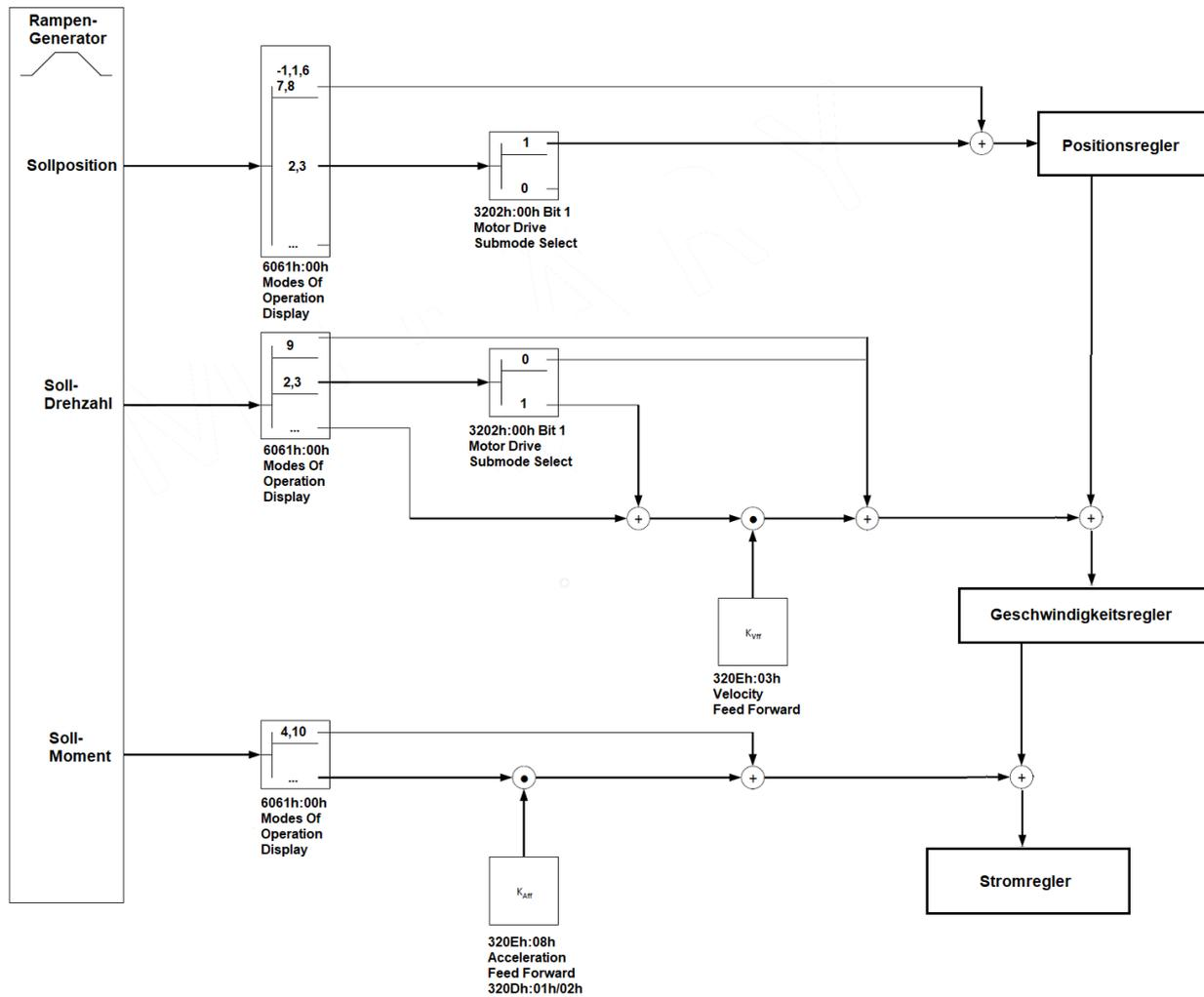
Der Faktor für die *Spannungsvorsteuerung* wird im Objekt 320E<sub>h</sub>:0D<sub>h</sub> in Promille der Spannung definiert, die benötigt wird, um den Sollstrom zu erzeugen. Ist der Faktor 1000‰ (Werkseinstellung), steht die Spannung sofort zur Verfügung und der Iststrom erreicht sehr schnell den Sollstrom. Dadurch existiert praktisch keine Regelabweichung beim Beschleunigen und der Stromregler wird entlastet.
