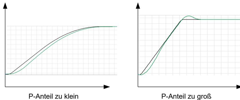
Ist die Nachstellzeit zu klein, neigt das System zu Schwingungen zu. Ist die Nachstellzeit zu groß, wird die Abweichung zu langsam ausgeregelt.
