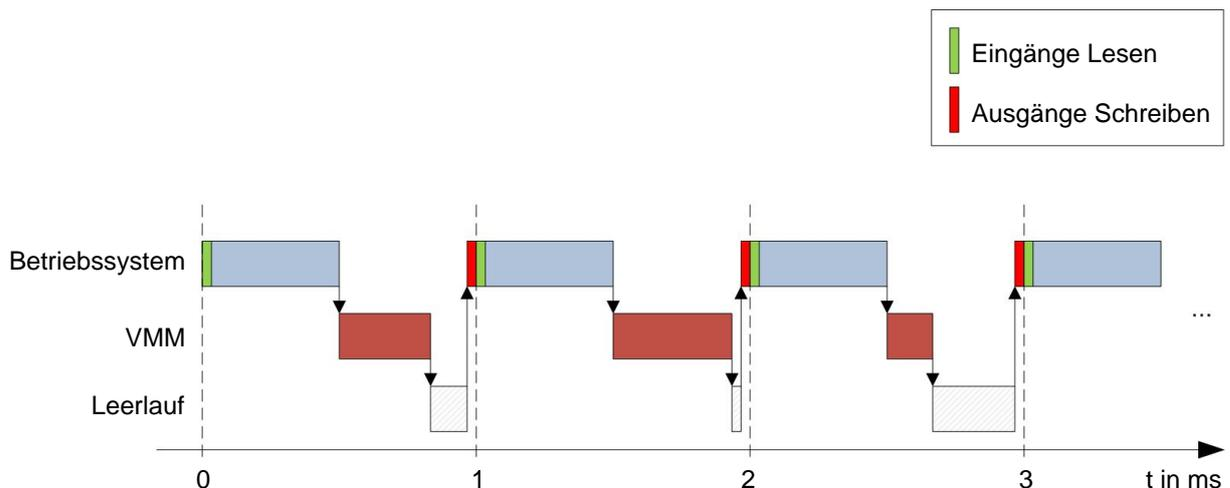
Sofern das System feststellt, dass das Benutzerprogramm mehr als die ihm zugeteilte Zeit benötigt, wird dieses beendet und im Objektverzeichnis ein Fehlercode gesetzt. Bei der Entwicklung von Benutzerprogrammen ist daher speziell bei zeitintensiveren Aufgaben eine sorgfältige Überprüfung des Laufzeitverhaltens durchzuführen. So empfiehlt sich daher beispielsweise die Verwendung von Tabellen, anstatt einen Sinuswert über eine `sin` Funktion zu berechnen.
