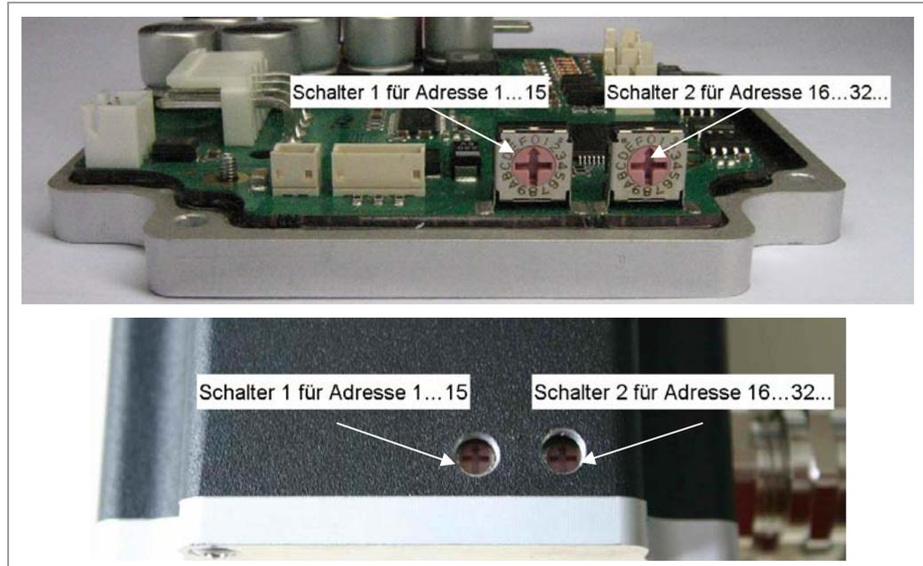
Mit Schalter 1 (links) wird die 1er-Stelle, mit Schalter 2 (rechts) die 16er-Stelle der Adresse eingestellt.
