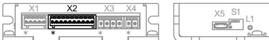
Die Umschaltung zwischen 24 V (3240<sub>h</sub>:06="1") und 5 V (3240<sub>h</sub>:06="0") erfolgt über das Objekt 3240<sub>h</sub>, ebenso wie die Umschaltung von "single-ended" (3240<sub>h</sub>:07="0") auf "differenziell" (3240<sub>h</sub>:07="1").
