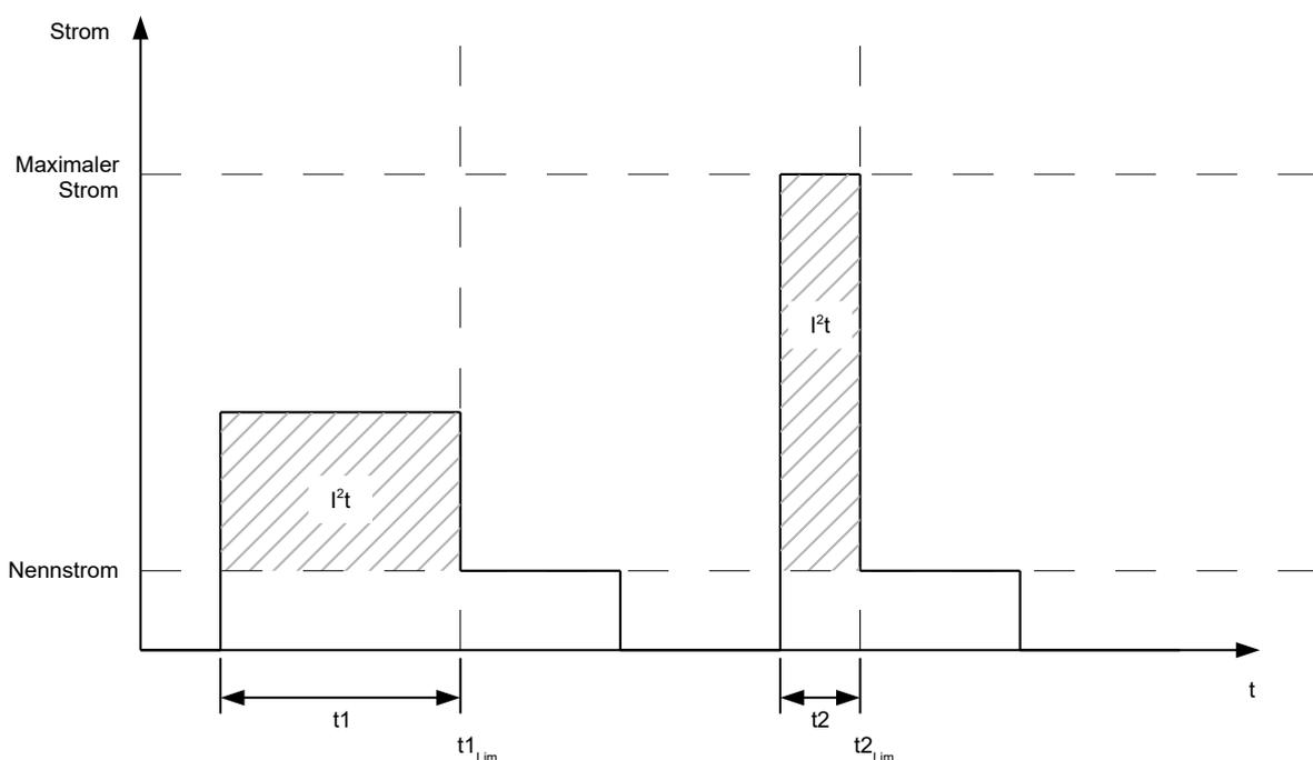
Im ersten Abschnitt  $t_1$  ist der Stromwert höher als der Nennstrom. Am Zeitpunkt  $t_{1\text{Lim}}$  wird  $I_{t_{1\text{Lim}}}^2$  erreicht und der Strom wird auf Nennstrom begrenzt. Danach kommt während der Dauer  $t_2$  ein Strom, der dem Maximalstrom entspricht. Dementsprechend ist der Wert für  $I_{t_{1\text{Lim}}}^2$  schneller erreicht, als im Zeitraum  $t_1$ .
