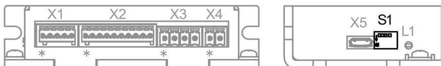
Über die DIP-Schalter können Sie einen der *speziellen Fahrmodi* auswählen. Siehe Kapitel **Spezielle Fahrmodi (Takt-Richtung und Analog-Drehzahl)**.
