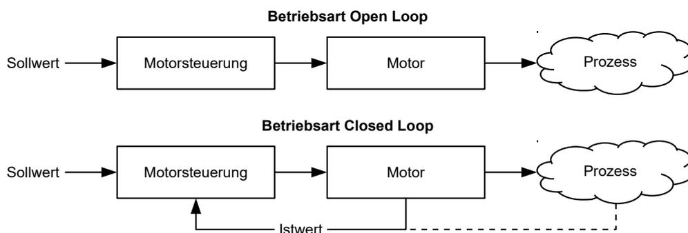
Aufgrund einer fehlenden Rückführung ist bei der C5 die Betriebsart *Closed Loop* nicht möglich.
