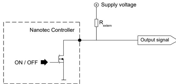
Bei einer Versorgungsspannung von +24 V wird ein Widerstandswert  $R_{\text{extern}}$  von 10 k $\Omega$  empfohlen.
