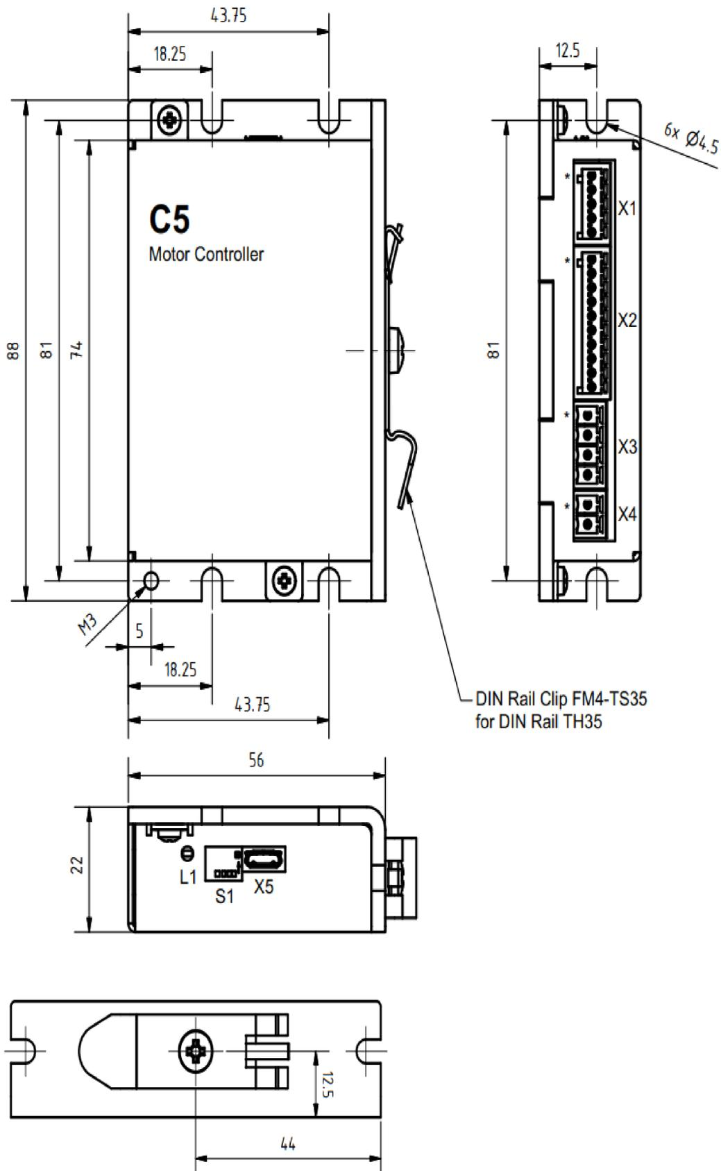
Sie können die Steuerung mit Schrauben an den seitlichen Laschen auf eine ebene Montagefläche oder mit der mitgelieferten Hutschieneclammer an einer TH35-Hutschiene in Ihrem Schaltschrank befestigen.
