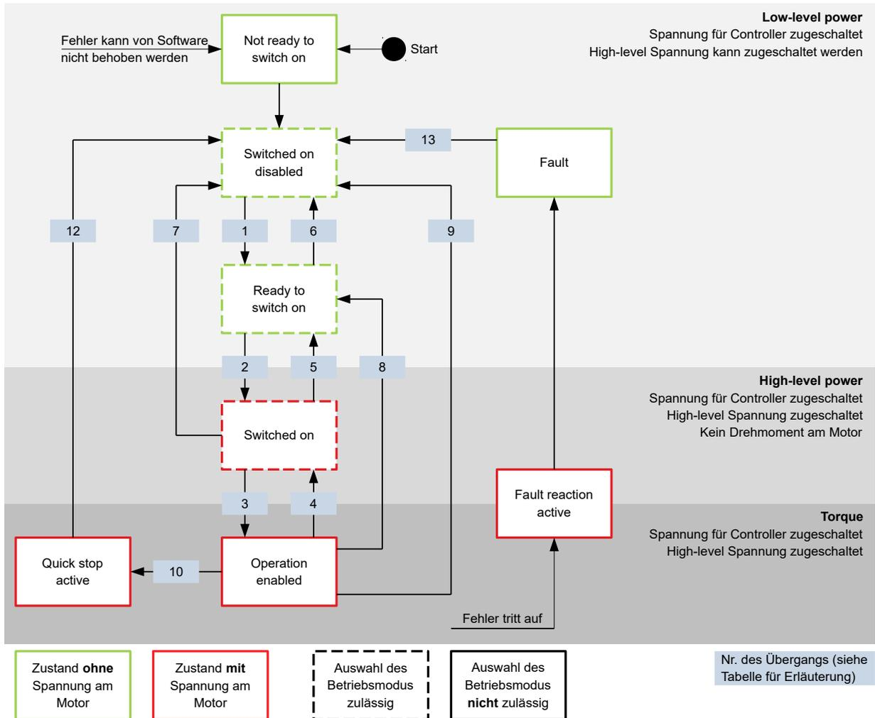
In der nachfolgenden Tabelle sind die Bit-Kombinationen für das Controlword aufgelistet, die zu den entsprechenden Zustandsübergängen führen. Ein X entspricht dabei einem nicht weiter zu berücksichtigenden Bit-Zustand. Einzige Ausnahme ist das Rücksetzen des Fehlers (Fault reset): Der Übergang wird nur durch steigende Flanke des Bits angefordert.
