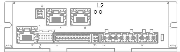
Die rote LED *ERR* (L2) zeigt einen der folgenden Status der Steuerung (*EtherCAT-Slave*) an:
