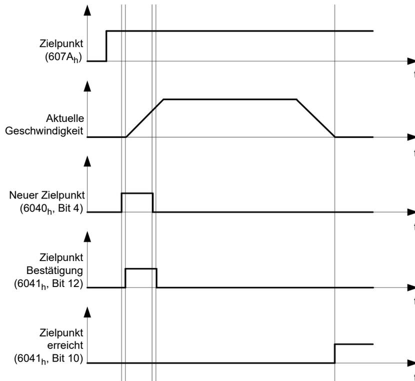
Die Steuerung kann das Bit 4 im Objekt **6040<sub>h</sub>** (Controlword) auch selbstständig zurücksetzen. Das wird mit den Bits 4 und 5 des Objektes **60F2<sub>h</sub>** eingestellt.
