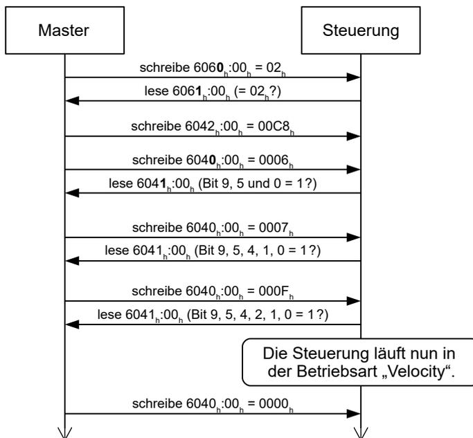
4. Um den Motor zu stoppen, setzen Sie das Controlword (**6040<sub>h</sub>**) auf "0".
