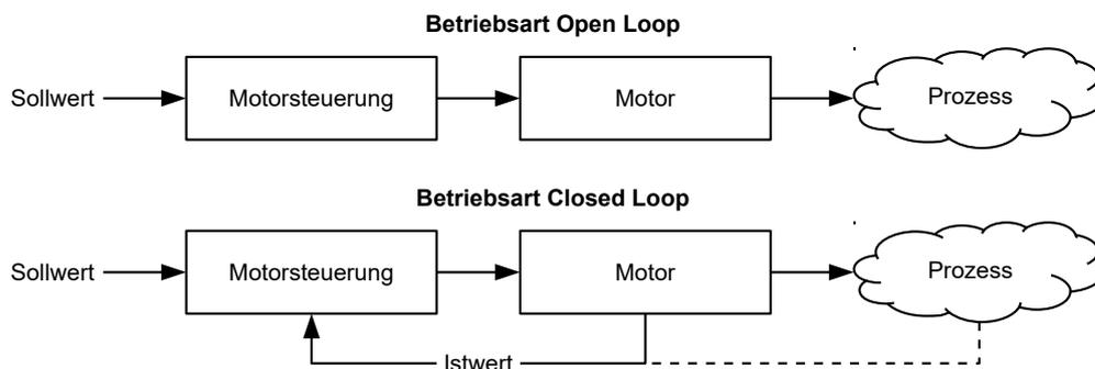
Neben den physischen Rückführsystemen (beispielsweise über Encoder oder Hallsensoren) kommen auch modellbasierte Rückführsysteme, die alle unter dem Überbegriff *Sensorless* bekannt sind, zum Einsatz. Beide Rückführsysteme können auch in Kombination eingesetzt werden, um die Qualität der Regelung weiter zu verbessern.
