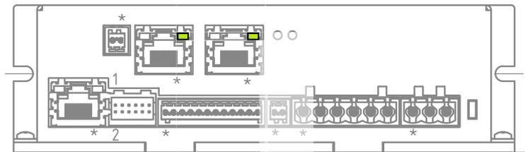
Die grüne LED *LINK* ist an, wenn das EtherCAT-Kabel angeschlossen ist und blinkt bei Datenverkehr.
