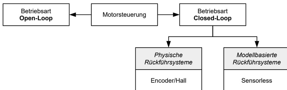
Nachfolgend werden alle möglichen Kombinationen von Betriebsarten und Rückführsysteme im Bezug auf die Motorentchnik zusammengefasst. Die Unterstützung der jeweiligen Betriebsart und Rückführung ist steuerungsspezifisch und in den Kapiteln **Anschlussbelegung** und **Betriebsmodi** nachzulesen.
