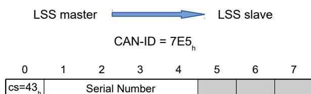
**Byte 0 : CS (Command Specifier)**Wert = "43<sub>h</sub>"**Bytes 1-4: mode**Serial Number: siehe 1018<sub>h</sub>:04<sub>h</sub>**Bytes 5-7 :**reserviert (=0<sub>h</sub>)
