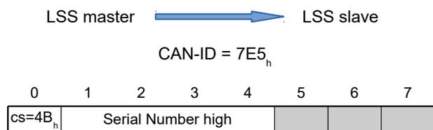
**Byte 0 : CS (Command Specifier)**Wert = "4B<sub>h</sub>"**Bytes 1-4: Serial Number high**höchste *Serial Number* des Bereichs: siehe 1018<sub>h</sub>:04<sub>h</sub>**Bytes 5-7 :**reserviert (=0<sub>h</sub>)**LSS identify slave service**
