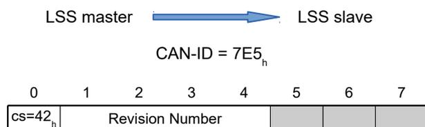
**Byte 0 : CS (Command Specifier)**Wert = "42<sub>h</sub>"**Bytes 1-4: Revision Number***Revision Number*: siehe 1018<sub>h</sub>:03<sub>h</sub>**Bytes 5-7 :**reserviert (=0<sub>h</sub>)
