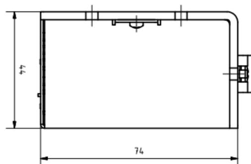
Sie können die Steuerung mit Schrauben an den seitlichen Laschen auf eine ebene Montagefläche oder mit der mitgelieferten Hutschieneklammer an einer TH35-Hutschiene in Ihrem Schaltschrank befestigen.
