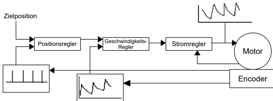
In der Betriebsart *Slow Speed* fährt der Motor im Gegenteil mit konstantem Phasenstrom, wie im *Open Loop*. Der Schleppfehler wird aber über den Encoder überwacht und die Vektorregelung des Magnetfelds wird ggf. aktiviert, wie im *Closed Loop*.
