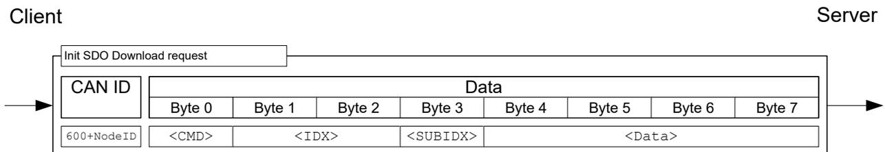
Dabei ist das Byte  $\langle \text{CMD} \rangle$  abhängig von der Länge der Daten, welche geschrieben werden sollen.  $\langle \text{CMD} \rangle$  kann einer der folgenden Werte sein:
