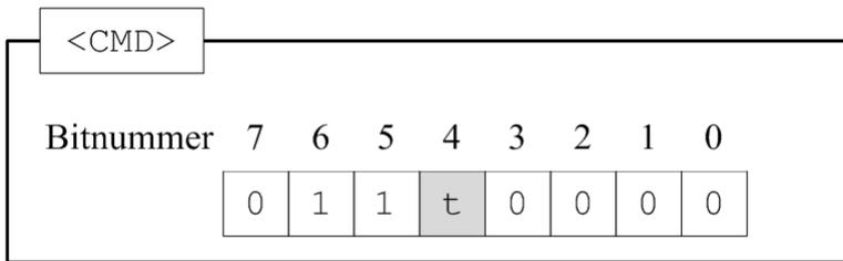
Das Bit mit der Bezeichnung  $t$  alterniert mit jeder Anforderung ("toggle bit"). Es beginnt mit jedem Transfer bei 0, auch wenn der vorherige Transfer abgebrochen wurde.
