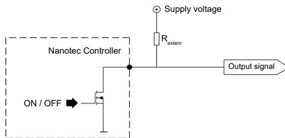
Bei einer Versorgungsspannung von +24 V wird ein Widerstandswert  $R_{\text{extern}}$  von 10 k $\Omega$  empfohlen.
