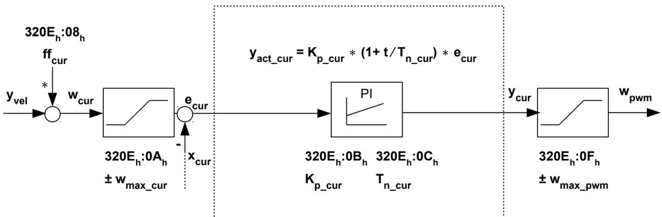
Für jeden Regler können Sie eine maximale Regelabweichung ( $e_{max}$ ) und einen Verstärkungsfaktor ( $K_p$ ) einstellen, die den Ausgang des Reglers (Stellgröße) bestimmen, unter Berücksichtigung der Limitierung der Stellgröße ( $y_{max}$ ).
