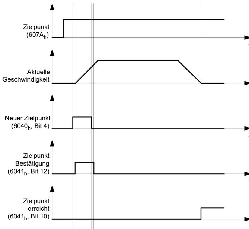
Die Steuerung kann das Bit 4 im Objekt  $6040_h$  (Controlword) auch selbstständig zurücksetzen. Das wird mit den Bits 4 und 5 des Objektes  $60F2_h$  eingestellt.
