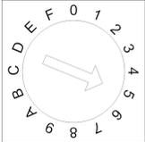
Mit der Zahlenkombination aus beiden Drehschaltern können Sie die Quelle für die CANopen Node-ID und die Baudrate einstellen.
