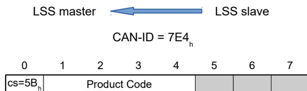
**Byte 0 : CS (Command Specifier)**Wert = "5B<sub>h</sub>"**Bytes 1-4: Product Code**Product Code: siehe 1018<sub>h</sub>:02<sub>h</sub>**Bytes 5-7 :**reserviert (=0<sub>h</sub>)
