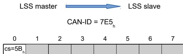
**Byte 0 : CS (Command Specifier)**Wert = "5B<sub>h</sub>"**Bytes 1-7 :**reserviert (=0<sub>h</sub>)
