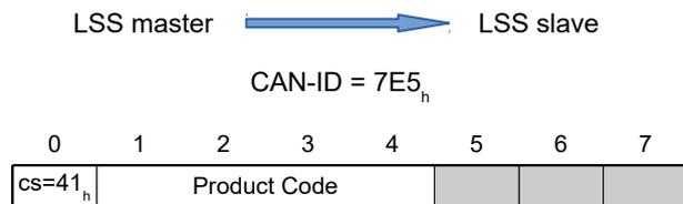
**Byte 0 : CS (Command Specifier)**Wert = "41<sub>h</sub>"**Bytes 1-4: Product Code***Product Code*: siehe 1018<sub>h</sub>:02<sub>h</sub>**Bytes 5-7 :**reserviert (=0<sub>h</sub>)
