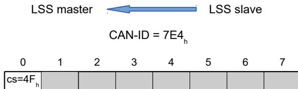
**Byte 0 : CS (Command Specifier)**Wert = "4F<sub>h</sub>"**Bytes 1-7 :**reserviert (=0<sub>h</sub>)**8.3.4 Beispiel**
