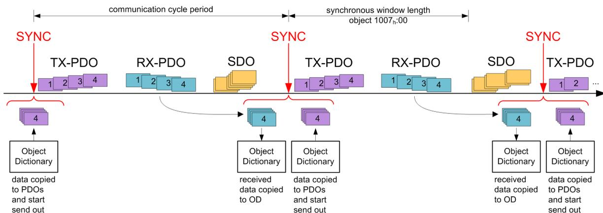
Falls der *Sync Producer* einen *Sync Counter* unterstützt, enthält die Sync-Nachricht einen zusätzlichen 1-Byte-Zählwert. Dieser Zähler erhöht sich um den Wert "1" pro gesendete Sync-Nachricht und wird jedes Mal zurückgesetzt, wenn er den Wert von  $1019_h$  *Synchronous Counter Overflow Value* erreicht.
