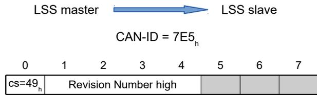
**Byte 0 : CS (Command Specifier)**Wert = "49<sub>h</sub>"**Bytes 1-4: Revision Number high**höchste *Revision Number* des Bereichs: siehe 1018<sub>h</sub>:03<sub>h</sub>**Bytes 5-7 :**reserviert (=0<sub>h</sub>)
