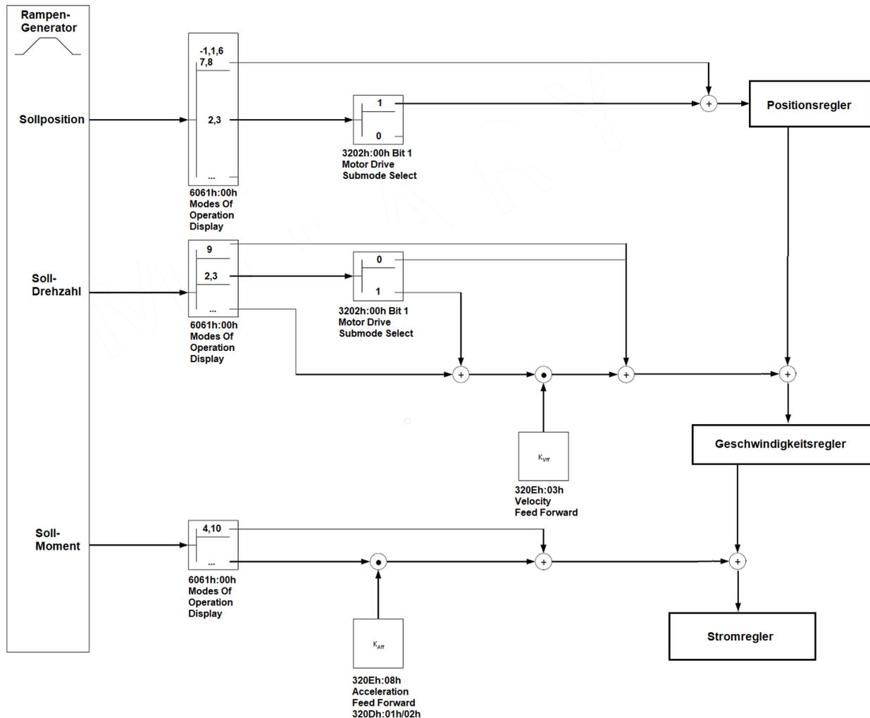
Der Faktor für die *Spannungsvorsteuerung* wird im Objekt  $320E_h:0D_h$  in Promille der Spannung definiert, die benötigt wird, um den Sollstrom zu erzeugen. Ist der Faktor 1000‰ (Werkseinstellung), steht die Spannung sofort zur Verfügung und der Iststrom erreicht sehr schnell den Sollstrom. Dadurch existiert praktisch keine Regelabweichung beim Beschleunigen und der Stromregler wird entlastet.
