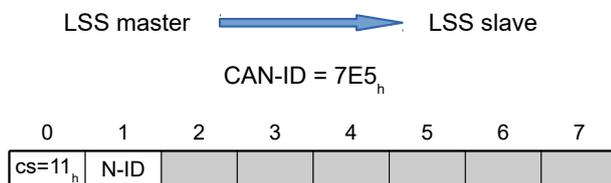
**Byte 0 : CS (Command Specifier)**Wert = "11<sub>h</sub>"**Byte 1: N-ID (Node-ID)**gültige Node-ID zwischen 01<sub>h</sub> und 7F<sub>h</sub>**Bytes 2-7 :**reserviert (=0<sub>h</sub>)
