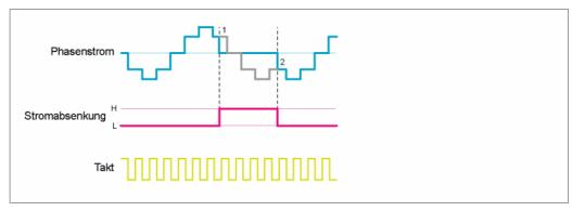
Die graufarbenen Linien im Bild zeigen, dass die Endstufe intern den Motor vier weitere Schritte von der Position 1 zur Position 2 geführt hat. So wird bei der Reaktivierung des Enable-Signals (Pegel auf Low) der Motor von der Position 2 aus weiterbetrieben (nur bei bleibender Versorgungsspannung  $V_{BB}$  und konstanter Taktfrequenz).
