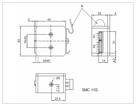
A: Halteclip für DIN-Tragschiene
