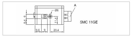
A: Halteclip für DIN-Tragschiene
