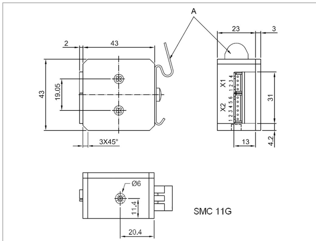
A: Halteclip für DIN-Tragschiene
