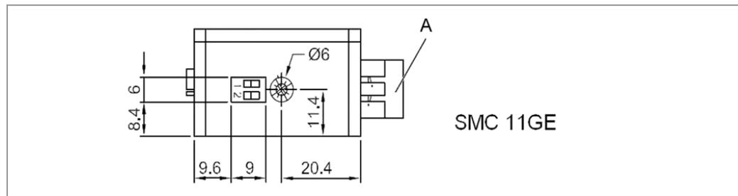
A: Halteclip für DIN-Tragschiene
