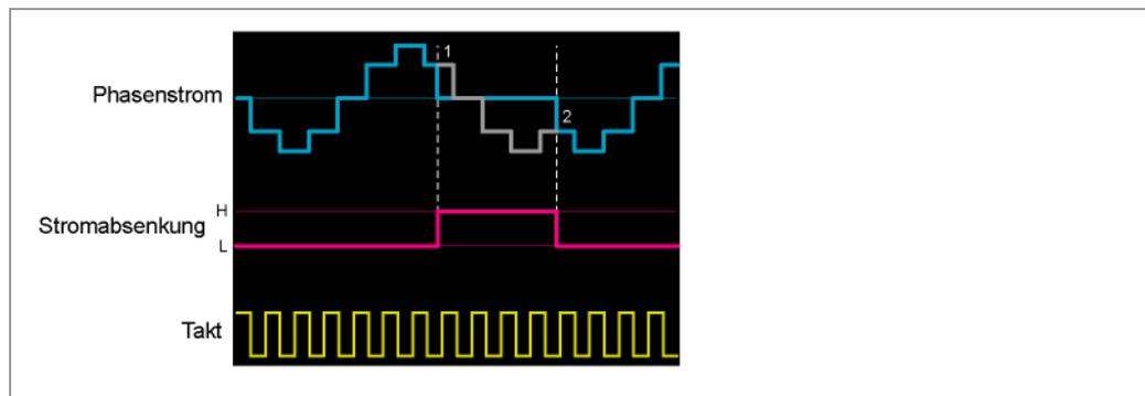
Die graufarbenen Linien im Bild zeigen, dass die Endstufe intern den Motor vier weitere Schritte von der Position 1 zur Position 2 geführt hat. So wird bei der Reaktivierung des Enable-Signals (Pegel auf Low) der Motor von der Position 2 aus weiterbetrieben (nur bei bleibender Versorgungsspannung  $V_{BB}$  und konstanter Taktfrequenz).
