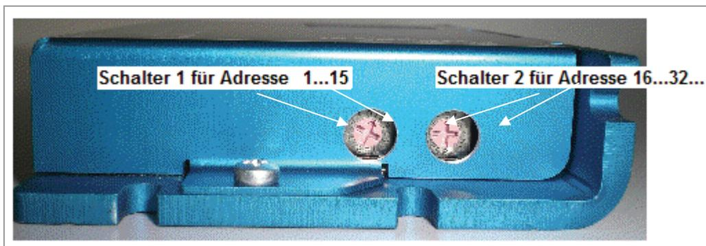
Mit Schalter 1 (links) wird die 1er-Stelle, mit Schalter 2 (rechts) die 16er-Stelle der Adresse eingestellt.
