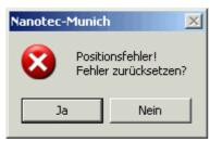
Der Fehler kann durch Betätigung der Schaltfläche <Ja> zurückgesetzt werden.
