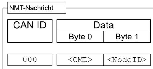
Das <CMD> entspricht dabei einem der folgenden Bytes (siehe auch Legende in der Abbildung des NMT-Zustandsdiagramms):
