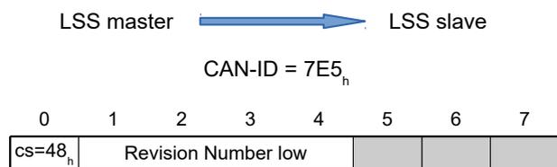
**Byte 0 : CS (Command Specifier)**Wert = "48<sub>h</sub>"**Bytes 1-4: Revision Number low**niedrigste *Revision Number* des Bereichs: siehe 1018<sub>h</sub>:03<sub>h</sub>**Bytes 5-7 :**reserviert (=0<sub>h</sub>)
