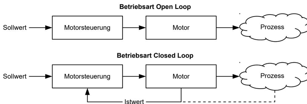
Neben den physischen Rückführsystemen (beispielsweise über Encoder oder Hallsensoren) kommen auch modellbasierte Rückführsysteme zum Einsatz, die alle unter dem Überbegriff *Sensorless* bekannt sind. Beide Rückführsysteme können auch in Kombination eingesetzt werden, um die Qualität der Regelung weiter zu verbessern.
