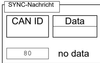
Für den SYNC-Betrieb wird in der Regel für die RX-PDOs der Übertragungsmodus (Transmission Type) 0 verwendet (Daten werden mit dem nächsten SYNC gültig), für die TX-PDOs wird ein Übertragungsmodus zwischen 1-240 gewählt. (Details: siehe Kapitel [Process Data Object \(PDO\)](#)).
