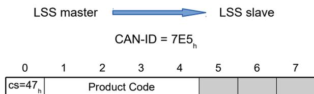
**Byte 0 : CS (Command Specifier)**Wert = "47<sub>h</sub>"**Bytes 1-4: Product Code**Product Code: siehe 1018<sub>h</sub>:02<sub>h</sub>**Bytes 5-7 :**reserviert (=0<sub>h</sub>)
