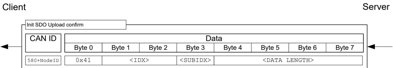
Damit gilt die Initialisierung als abgeschlossen, im Anschluss erfolgt nur noch der Upload der Daten. Ein Datenpaket wird mit folgenden SDO-Request angefordert:
