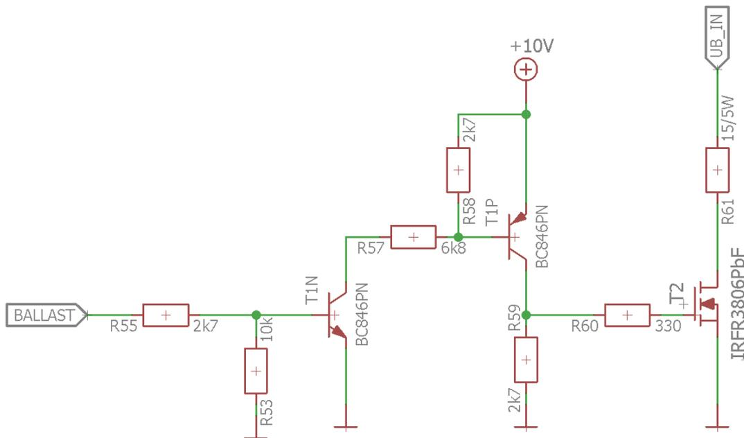
Der verwendete Ballast-Widerstand ist ein CR257-05T15R von VITROHM. Angesteuert wird die Schaltung über den Pin *BALLAST* (B27).
