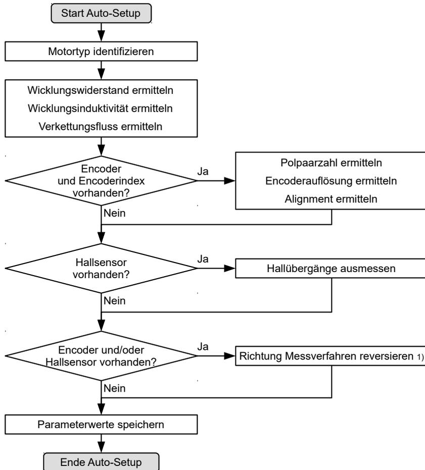
1) Zum Ermitteln der Werte wird die Richtung des Messverfahrens reversiert und die Flankenerkennung erneut ausgewertet.
