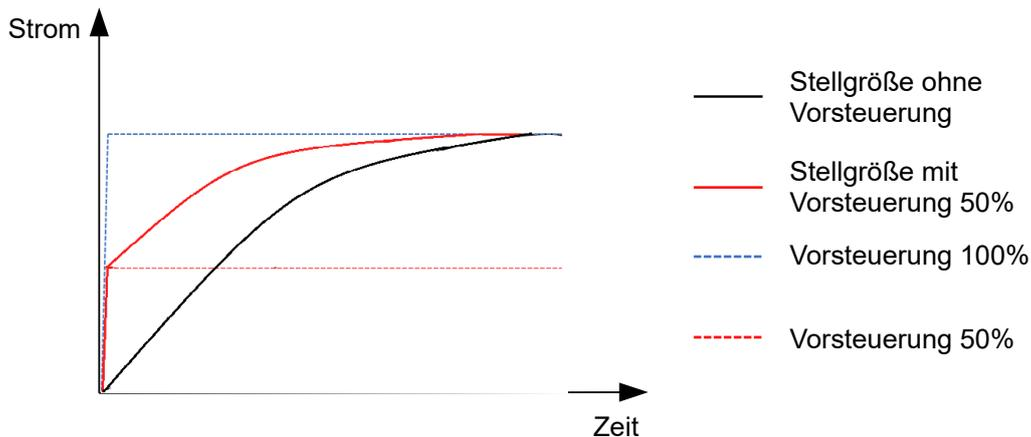
Der Faktor für die *Geschwindigkeitsvorsteuerung* wird im Objekt  $321D_h:03_h$  in Promille des Ausgangs des Rampengenerators ( $606B_h$ ) eingestellt und vor dem Geschwindigkeitsregler zum Ausgang des Positionsreglers addiert. Die *Geschwindigkeitsvorsteuerung* ist in allen Modi mit Positionsregelkreis aktiv:
