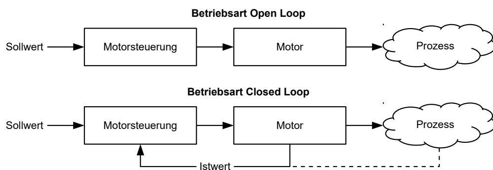
Neben den physischen Rückföhrysystmen (beispielsweise über Encoder oder Hallsensoren) kommen auch modellbasierte Rückföhrysystmen zum Einsatz, die alle unter dem Überbegriff *Sensorless* bekannt sind. Beide Rückföhrysystmen können auch in Kombination eingesetzt werden, um die Qualität der Regelung weiter zu verbessern.
