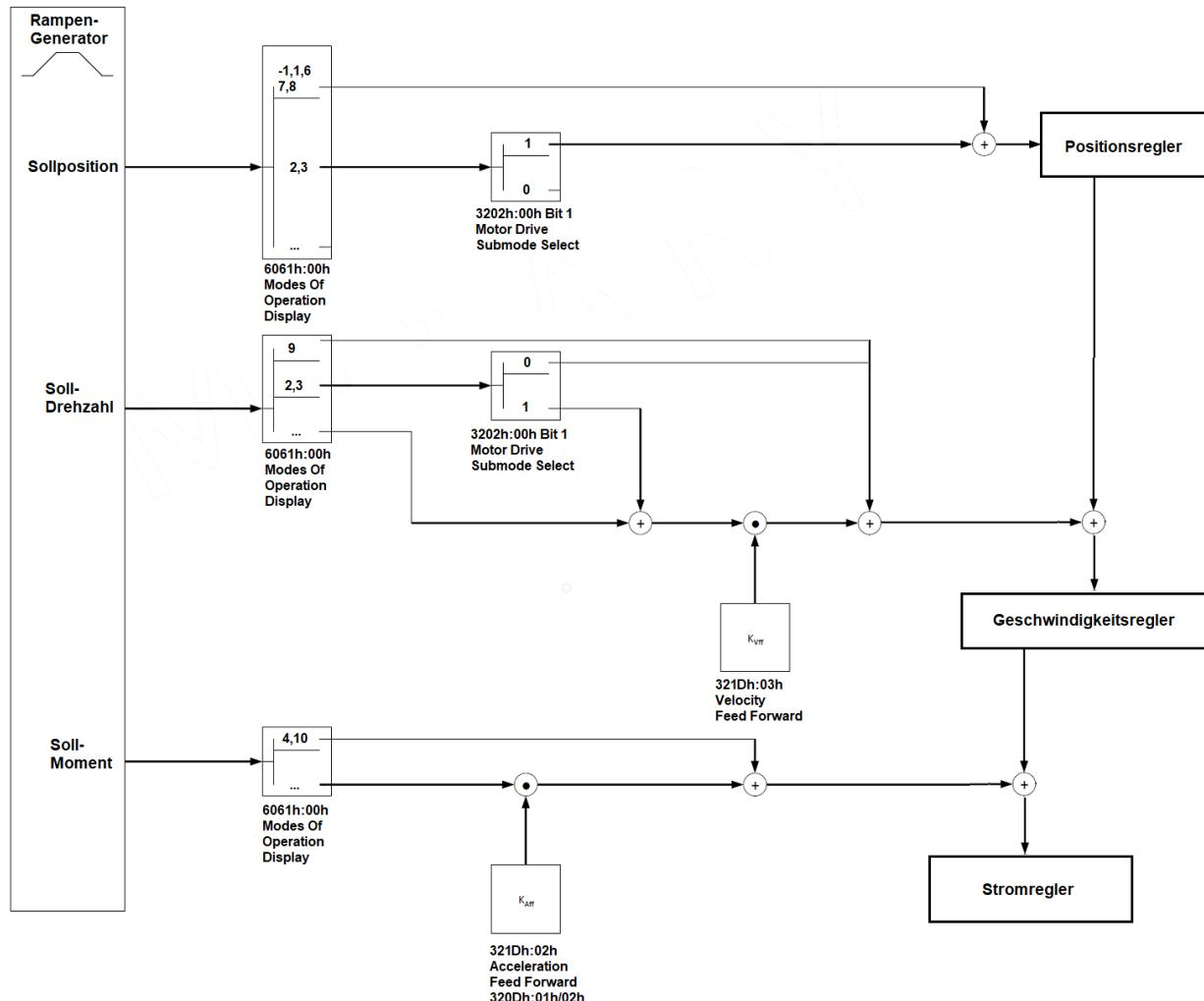
Der Faktor für die *Spannungsvorsteuerung* wird im Objekt 321D<sub>h</sub>:01<sub>h</sub> in Promille der Spannung definiert, die benötigt wird, um den Sollstrom zu erzeugen. Ist der Faktor 1000% (Werkseinstellung), steht die Spannung sofort zur Verfügung und der Iststrom erreicht sehr schnell den Sollstrom. Dadurch existiert praktisch keine Regelabweichung beim Beschleunigen und der Stromregler wird entlastet.
