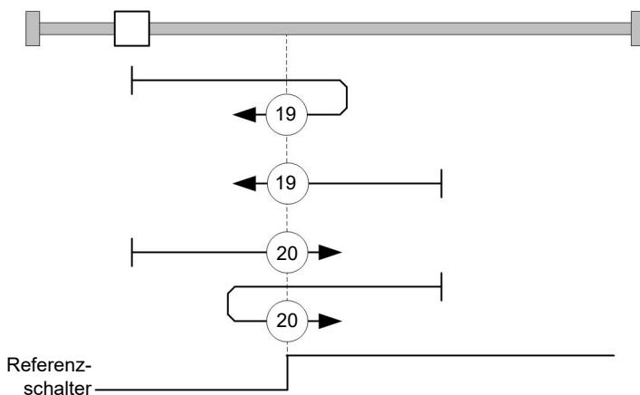
Bei den Methoden 21 und 22 (äquivalent zu Methoden 5 und 6) wird die rechte Schaltflanke des Referenzschalters als Referenz verwendet:
