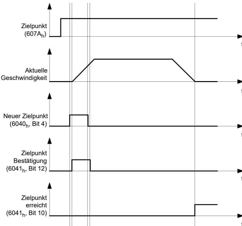
Die Steuerung kann das Bit 4 im Objekt 6040<sub>h</sub> (Controlword) auch selbstständig zurücksetzen. Das wird mit den Bits 4 und 5 des Objektes 60F2<sub>h</sub> eingestellt.
