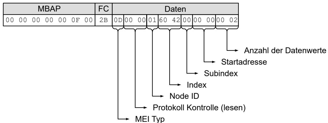
Als zusätzliches Beispiel nachfolgend eine Sequenz an Modbus-Nachrichten vom Master zum Slave, um den Motor im "Velocity" Modus sich drehen zu lassen:
