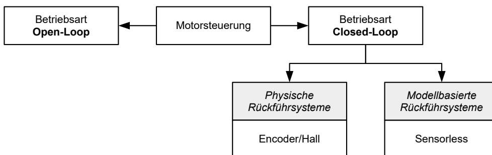
Nachfolgend werden alle möglichen Kombinationen von Betriebsarten und Rückföhrysystmen mit Bezug auf die Motortechnik zusammengefasst. Die Unterstützung der jeweiligen Betriebsart und Rückföhrlung ist steuerungsspezifisch und in den Kapiteln Anschlussbelegung und Betriebsmodi nachzulesen.
