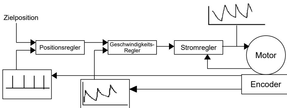
In der Betriebsart *Slow Speed* fährt der Motor im Gegenteil mit konstantem Phasenstrom, wie im *Open Loop*. Der Schleppfehler wird aber über den Encoder überwacht und die Vektorregelung des Magnetfelds wird ggf. aktiviert, wie im *Closed Loop*.
