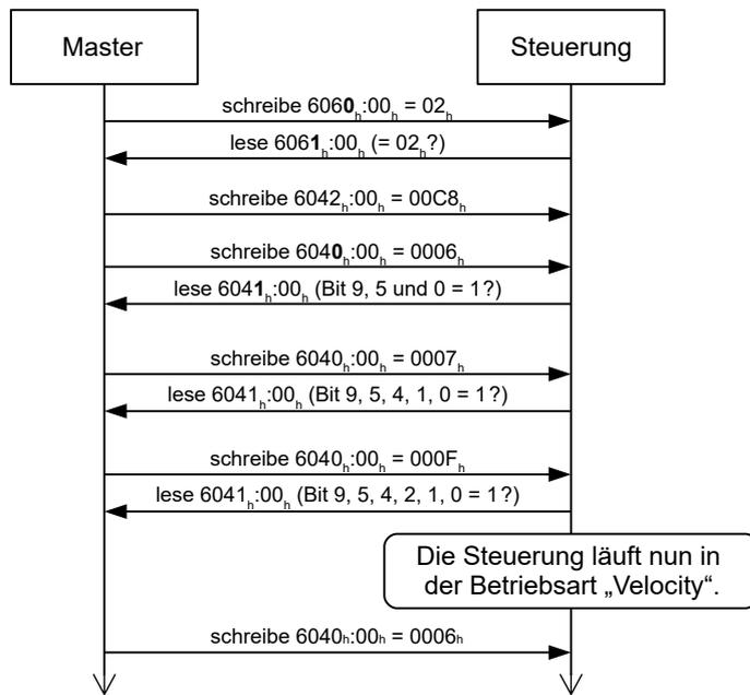
4. Um den Motor zu stoppen, setzen Sie das Controlword (6040<sub>h</sub>) auf "6".
