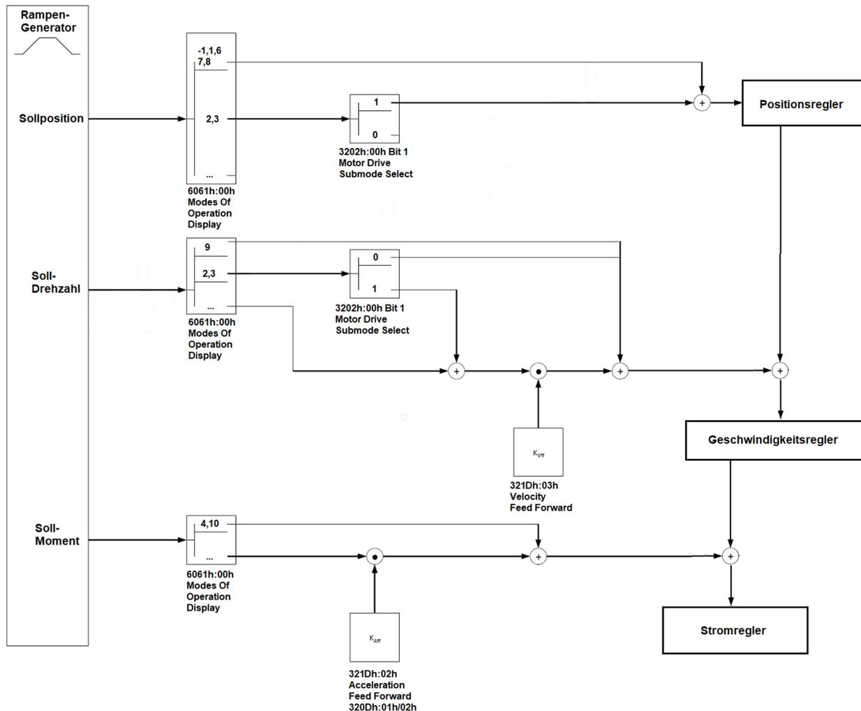
Der Faktor für die *Spannungsvorsteuerung* wird im Objekt  $321D_h:01_h$  in Promille der Spannung definiert, die benötigt wird, um den Sollstrom zu erzeugen. Ist der Faktor 1000‰ (Werkseinstellung), steht die Spannung sofort zur Verfügung und der Iststrom erreicht sehr schnell den Sollstrom. Dadurch existiert praktisch keine Regelabweichung beim Beschleunigen und der Stromregler wird entlastet.
