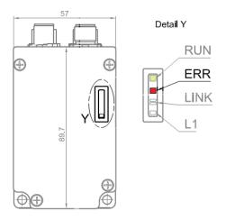
Die rote LED ERR zeigt einen der folgenden Status der Steuerung (EtherCAT-Slave) an:
