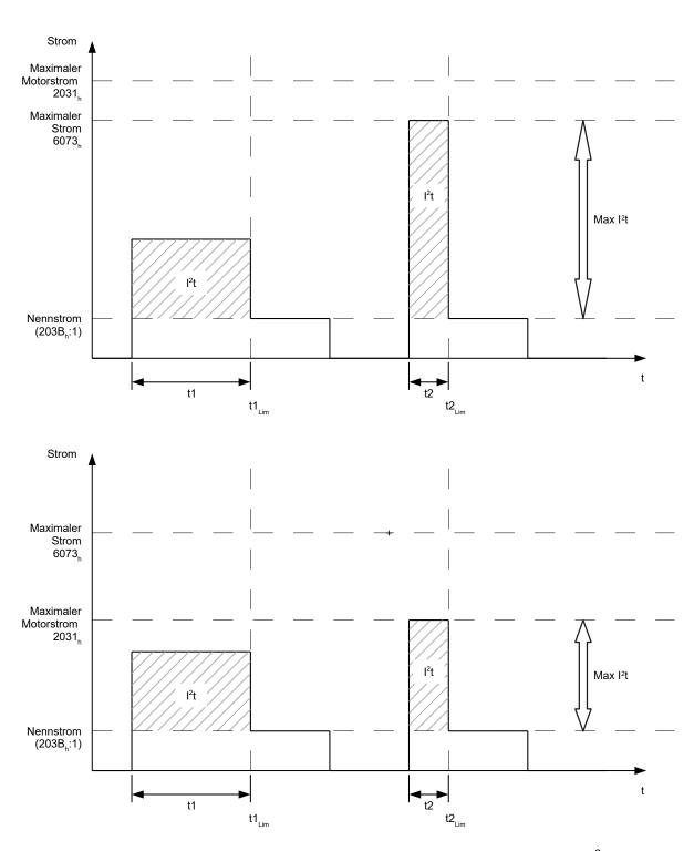
Im ersten Abschnitt t1 ist der Stromwert höher als der Nennstrom. Am Zeitpunkt  $t1_{Lim}$  wird  $l^2t_{Lim}$  erreicht und der Strom wird auf Nennstrom begrenzt. Danach kommt während der Dauer t2 ein Strom, der dem Maximalstrom entspricht. Dementsprechend ist der Wert für  $l^2t_{Lim}$  schneller erreicht, als im Zeitraum t1.
