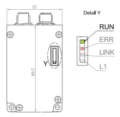
Die grüne LED RUN zeigt einen der folgenden Status der Steuerung (EtherCAT-Slave) an:
