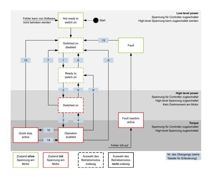
In der nachfolgenden Tabelle sind die Bit-Kombinationen für das Controlword aufgelistet, die zu den entsprechenden Zustandsübergängen führen. Ein X entspricht dabei einem nicht weiter zu berücksichtigenden Bit-Zustand. Einzige Ausnahme ist das Rücksetzen des Fehlers (Fault reset): Der Übergang wird nur durch steigende Flanke des Bits angefordert.
