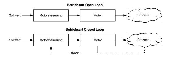
Neben den physischen Rückführsystemen (beispielsweise über Encoder oder Hallsensoren) kommen auch modellbasierte Rückführsysteme, die alle unter dem Überbegriff Sensorless bekannt sind, zum Einsatz. Beide Rückführsystemen können auch in Kombination eingesetzt werden, um die Qualität der Regelung weiter zu verbessern.
