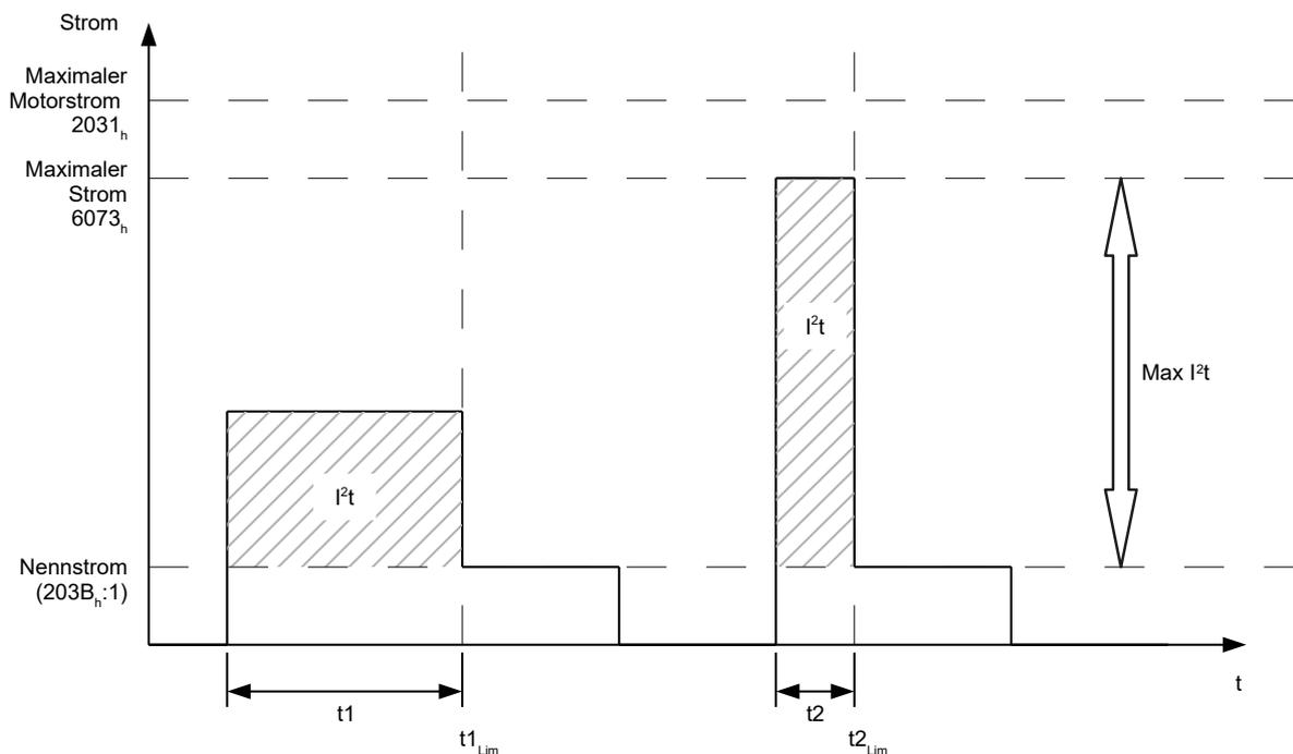
Im ersten Abschnitt  $t_1$  ist der Stromwert höher als der Nennstrom. Am Zeitpunkt  $t_{1Lim}$  wird  $I^2t_{Lim}$  erreicht und der Strom wird auf Nennstrom begrenzt. Danach kommt während der Dauer  $t_2$  ein Strom, der dem Maximalstrom entspricht. Dementsprechend ist der Wert für  $I^2t_{Lim}$  schneller erreicht, als im Zeitraum  $t_1$ .
