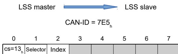
**Byte 0 : CS (Command Specifier)**Wert = "13<sub>h</sub>"**Byte 1: Table Selector**Wert = "00<sub>h</sub>": die Tabelle für die Baudrate aus dem *CiA 301* Standard wird benutzt.**Byte 2: Table Index**
