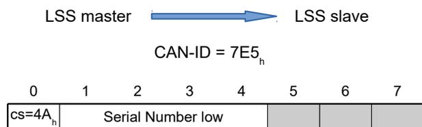
**Byte 0 : CS (Command Specifier)**Wert = "4A<sub>h</sub>"**Bytes 1-4: Serial Number low**niedrigste *Serial Number* des Bereichs: siehe 1018<sub>h</sub>:04<sub>h</sub>**Bytes 5-7 :**reserviert (=0<sub>h</sub>)
