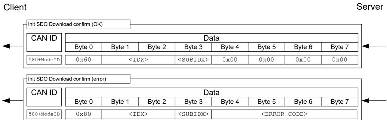
**Beispiel:** Setzen des Objekts  $607A_h:00_h$  (Target position, SIGNED32) auf den Wert  $3E8_h$  (=1000<sub>d</sub>) einer Steuerung mit der Node-ID 3:
