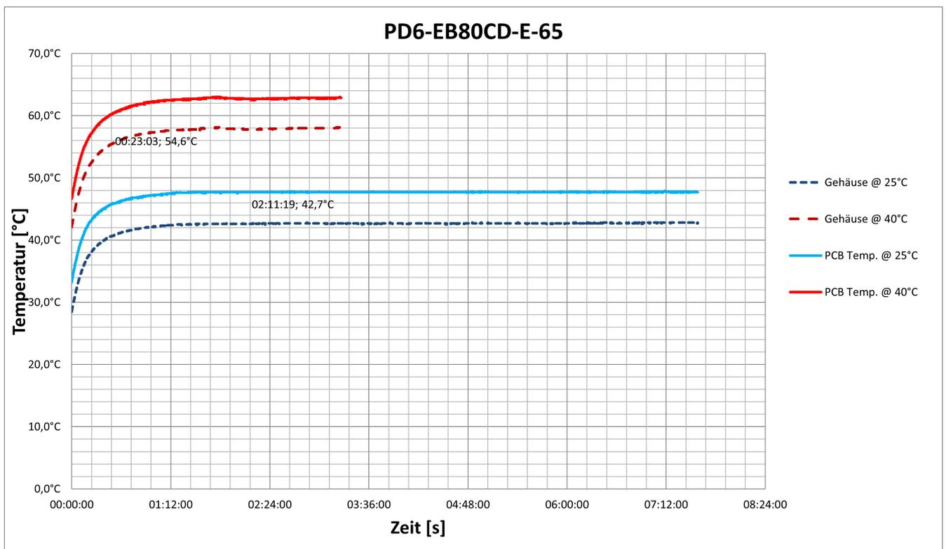
Sowohl bei 25 °C als auch bei 40 °C ist der Motor länger als 3 Stunden in Betrieb gewesen ohne Abschaltung. Die Temperatur hat nach ca. 30 Minuten ihr Maximum erreicht und ist danach stabil geblieben.
