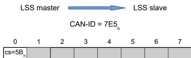
**Byte 0 : CS (Command Specifier)**Wert = "5B<sub>h</sub>"**Bytes 1-7 :**reserviert (=0<sub>h</sub>)Der LSS-Slave sendet seinen *Product Code* zurück:
