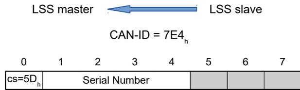
**Byte 0 : CS (Command Specifier)**Wert = "5D<sub>h</sub>"**Bytes 1-4: Serial Number**Serial Number: siehe 1018<sub>h</sub>:04<sub>h</sub>**Bytes 5-7 :**reserviert (=0<sub>h</sub>)**Inquire node-ID service**
