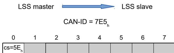
**Byte 0 : CS (Command Specifier)**Wert = "5E<sub>h</sub>"**Bytes 1-7 :**reserviert (=0<sub>h</sub>)
