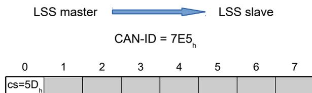
**Byte 0 : CS (Command Specifier)**Wert = "5D<sub>h</sub>"**Bytes 1-7 :**reserviert (=0<sub>h</sub>)
