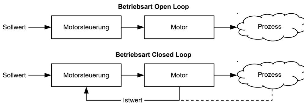
Neben den physischen Rückführsystemen (beispielsweise über Encoder oder Hallsensoren) kommen auch modellbasierte Rückführsysteme zum Einsatz, die alle unter dem Überbegriff *Sensorless* bekannt sind. Beide Rückführsysteme können auch in Kombination eingesetzt werden, um die Qualität der Regelung weiter zu verbessern.
