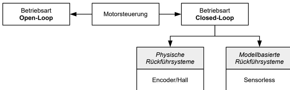
Nachfolgend werden alle möglichen Kombinationen von Betriebsarten und Rückführsystemen mit Bezug auf die Motortechnik zusammengefasst. Die Unterstützung der jeweiligen Betriebsart und Rückführung ist steuerungsspezifisch und in den Kapiteln *Anschlussbelegung* und *CiA 402-Betriebsmodi und State Machine* nachzulesen.
