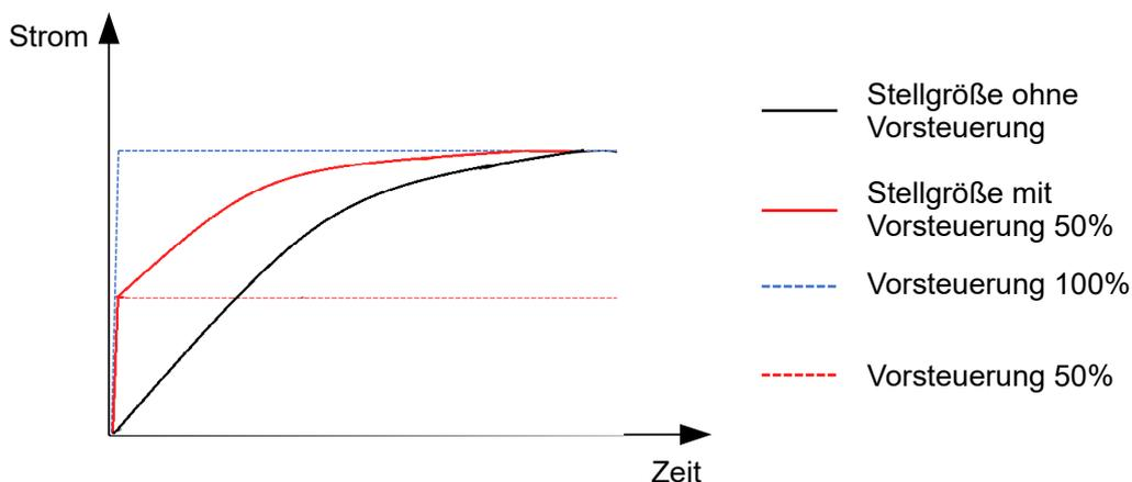
Der Faktor für die *Geschwindigkeitsvorsteuerung* wird im Objekt 321D<sub>h</sub>:03<sub>h</sub> in Promille des Ausgangs des Rampengenerators (606B<sub>h</sub>) eingestellt und vor dem Geschwindigkeitsregler zum Ausgang des Positionsreglers addiert. Die *Geschwindigkeitsvorsteuerung* ist in allen Modi mit Positionsregelkreis aktiv:
