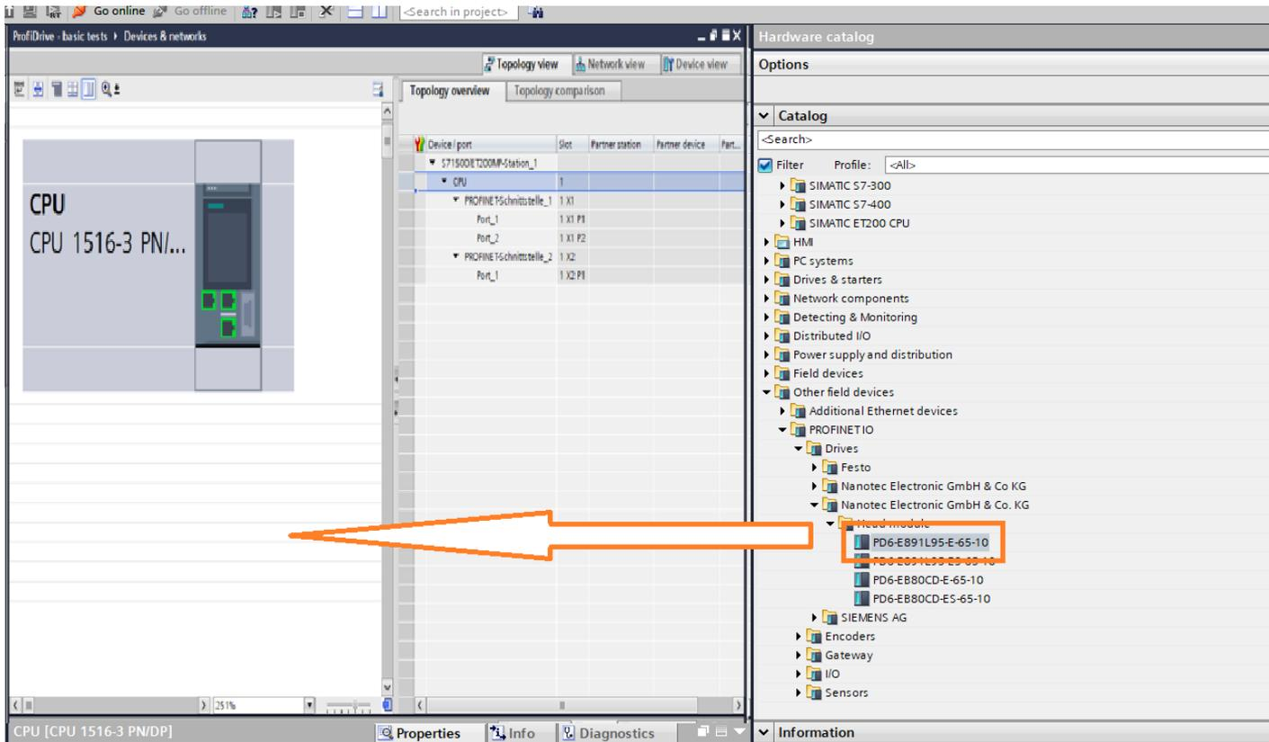
5. Verbinden Sie die Ports entsprechend der Verdrahtung und ordnen Sie die Nanotec-Steuerung der SPS ZU.
