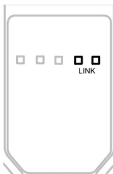
Die grünen LEDs *LINK* zeigen den Status der physikalischen Ethernet-Verbindung am PROFINET-Port 1/IN (links) und 2/OUT (rechts).
