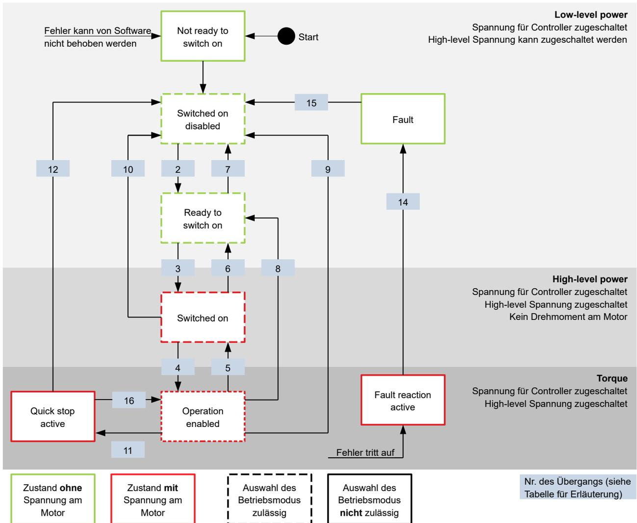
In der nachfolgenden Tabelle sind die Bit-Kombinationen für das Controlword aufgelistet, die zu den entsprechenden Zustandsübergängen führen. Ein X entspricht dabei einem nicht weiter zu berücksichtigenden Bit-Zustand. Ausnahmen sind das Zurücksetzen des Fehlers (Fault reset) und der Wechsel von *Quick Stop Active* nach *Operation Enabled*: Der Übergang wird nur durch steigende Flanke des Bits angefordert.
